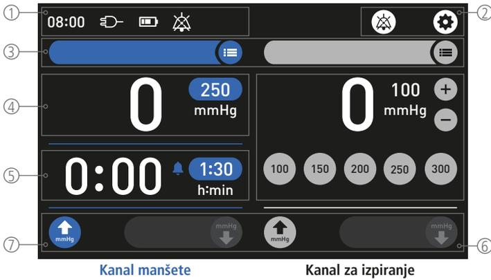
Glavni zaslon je razdeljen na vrstico stanja ① kontrolno ② vrstico, vrstico ③ kanalov, kontrolno ploščo ④ za tlak (kanal manšete), kontrolno ⑤ ploščo za čas alarma (kanal manšete), kontrolno ⑥ ploščo za tlak (kanal izpiranja) in kontrolno ⑦ ploščo za prezračevanje / razbremenjevanje.
