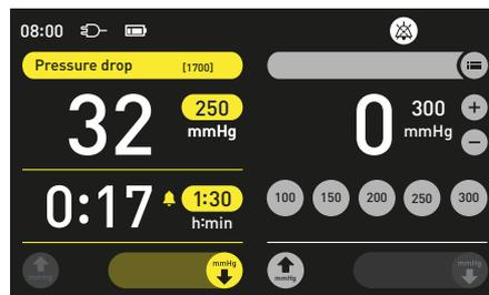
Napaka je prikazana v vrstici kanala. Kanal manšete se spreminja med barvo kanala in rumeno barvo.
